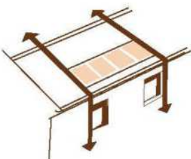
Alignement du champ de capteurs avec les ouvertures en façade
